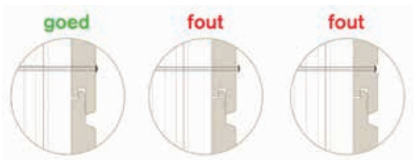
Nagelen bij een zichtbare bevestiging
