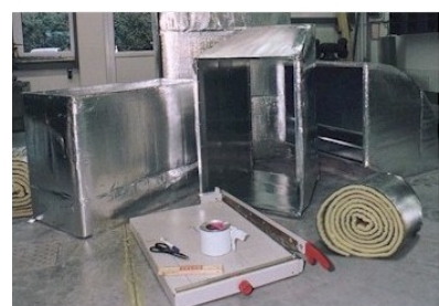
Isoleren van luchtkanalen
