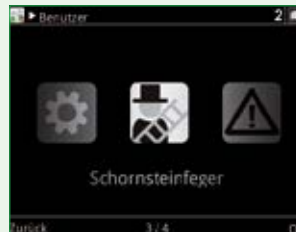
Schoorsteenveger toets voor inschakeling van de 2e WE voor rookgasmeting
